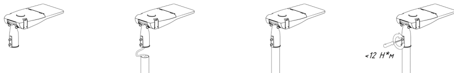
Рисунок 6 — монтаж светильника на опору (торшерный вариант).
