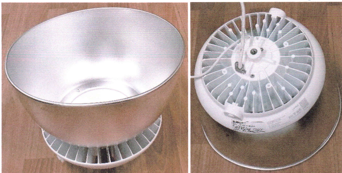
Рисунок 4 – Фотографии образца светильник светодиодный Geniled Kolokol 200Вт 5000K 80Ra, Закаленное стекло 120° с диффузором алюминиевым 90°
